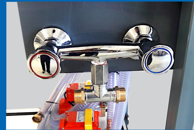
RUBINETTO CARICO ACQUA PULITA/ACQUA DI RECUPERO TAP FOR FRESH WATER/ RECOVERY WATER.
