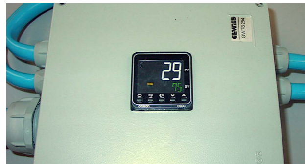
REGOLAZIONE TEMPERATURA CAPPA DI ASCIUGATURA INTERMEDIA TEMPERATURE CONTROL FOR INTERMEDIATE DRYING HOOD
