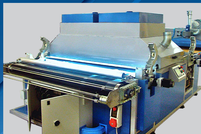
ROTOSCREEN-B2-1600 COLORI DI STAMPA A CILINDRO CON CAPPA DI ASCIUGATURA INTERMEDIA. ROTOSCREEN-B2-1600 DOUBLE PRINTING CYLINDER WITH INTERMEDIATE DYER.
