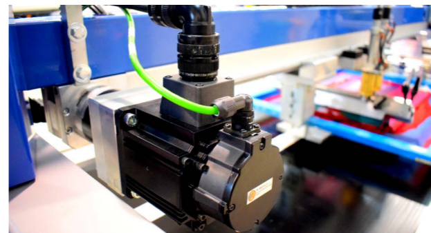
MOTORE BRUSHLESS SU UNITÀ DI STAMPA PER GARANTIRE LA PRECISIONE DELLA CORSA STAMPA BRUSHLESS MOTOR FOR ACCURATE STROKE
