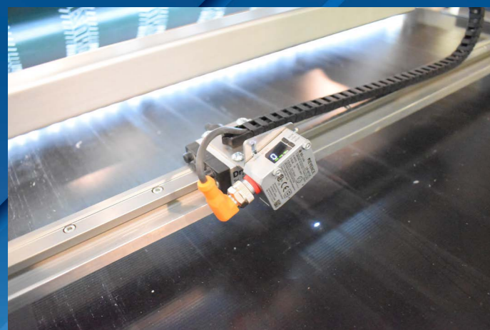
FOTOCELLA PER LETTURA TACCA SU NASTRO PHOTOCELL FOR READING NOTCH ON RIBBON
