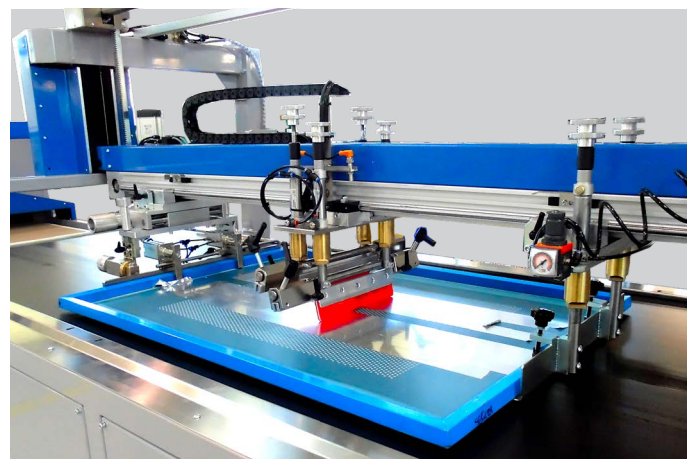
UNITÀ DI STAMPA POSTA LONGITUDINALMENTE RISPETTO ALL'AVANZAMENTO NASTRO SILK SCREEN PRINTING UNIT PLACED IN THE SAME DIRECTION IN WHICH THE NARROW FABRIC ADVANCE.
