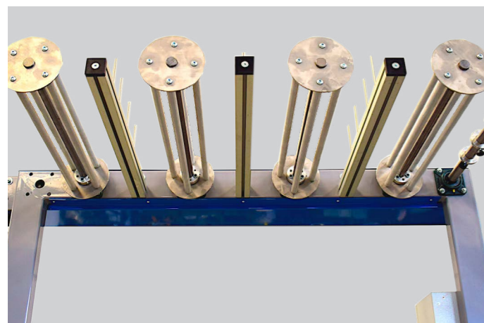
I NASTRI VENGONO SUDDIVISI SU PIÙ ASPI MOTORIZZATI/ FRIZIONATI THE NARROW FABRIC ARE SUBDIVIDED ON MORE MOTORIZED/ FRICTIONED REELS.
