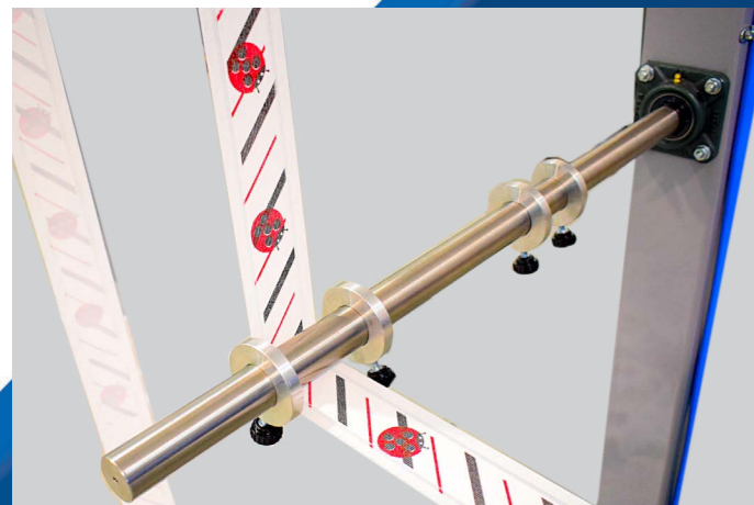
PRIMO PASSAGGIO GUIDATO CHE SUDDIVIDE I NASTRI FIRST STEP: GUIDES THAT DIVIDES THE RIBBON
