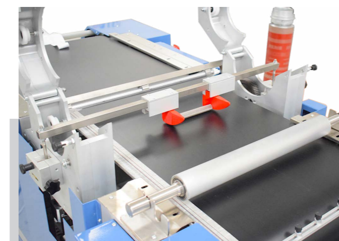
TONDINO ZIGRINATO MANTENUTO DA APPOSITI SUPPORTI CHE NE PERMETTONO LA ROTAZIONE. MILLD ROD WITH SUPPORT THAT ALLOW THE ROTATION.
