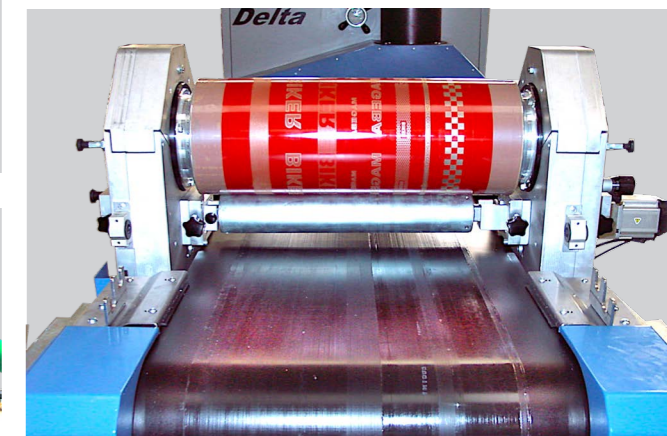
FASE DI STAMPA CON CONTROCILINDRO SU ROTOSCREEN-B 400 MM PRINTING FASE USING COUNTER-CYLINDER ON ROTOSCREEN-B 400 MM
