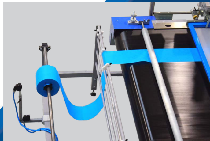
INTRODUZIONE PER BOBINE DI TESSUTO NON TESSUTO GESTITO DA FOTOCPELLULA INTRODUCTION FOR NON-WOVEN ROLLS MANAGED BY PHOTOCCELL
