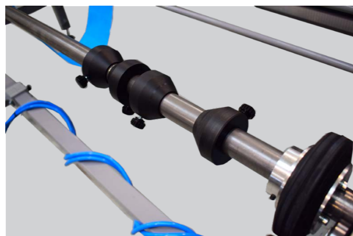
SUPPORTI CONICI PER FISSAGGIO BOBINE SUPPORT TO FIX NON-WOVEN FABRIC ROLLS
