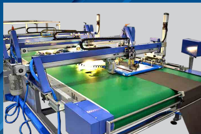
TAPPETO ADESIVO CHE GESTISCE L'AVANZAMENTO DEL ROTOLO. ADHESIVE CARPET THAT MANAGES THE ADVANCEMENT OF THE ROLL.
