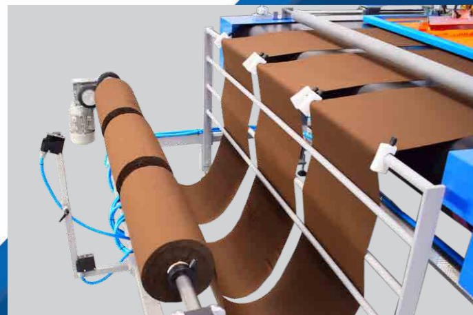
INTRODUZIONE PER BOBINE DI TESSUTO NON TESSUTO GESTITO DA FOTOCPELLULA INTRODUCTION FOR NON-WOVEN FABRIC ROLLS MANAGED BY PHOTOCCELL
