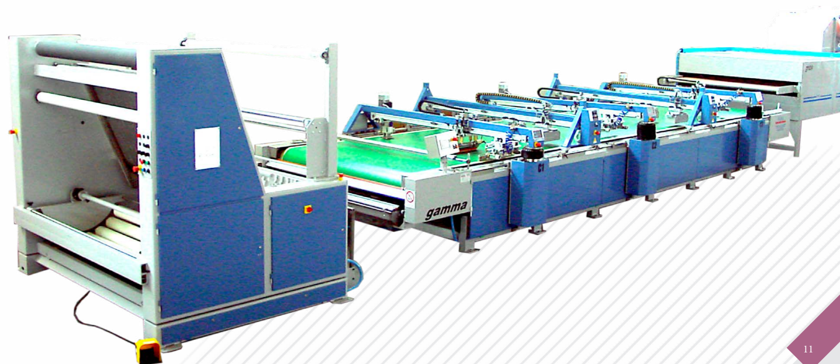
TAPPETO ADESIVO CHE GESTISCE L'AVANZAMENTO DEL ROTOLO. ADHESIVE CARPET THAT MANAGES THE ADVANCEMENT OF THE ROLL.
