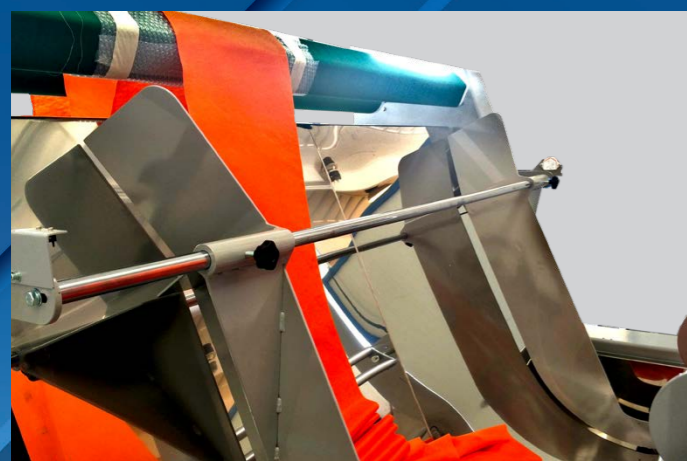
FASE DI FALDATURA NELLO J-BOX. J-BOX LOADING
