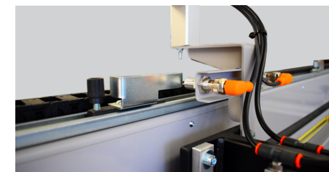
FINE CORSA CARRELLO STAMPA REGOLABILE ADJUSTABLE PRINT CARRIGE STROKE
