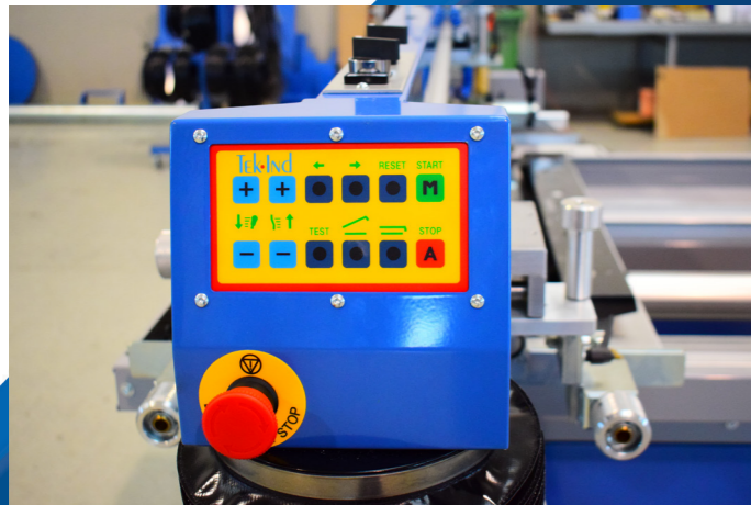
PANNELLO COMANDI UNITÀ DI STAMPA, POSIZIONATO SUL FIANCO SINISTRO O SOPRA L'UNITÀ DI STAMPA PRINTING CONTROL PANNEL PLACED ON THE LEFT SIDE OR OVER THE PRINTING UNIT
