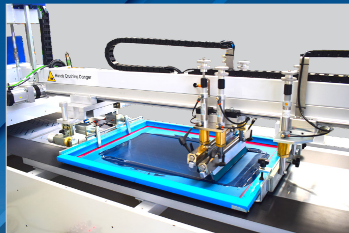
UNITÀ DI STAMPA SERIGRAFICA: DISPOSTA LONGITUDINALMENTE RISPETTO ALLO SVILUPPO DELLA BOBINA. LONGITUDINAL PRINTING UNIT
