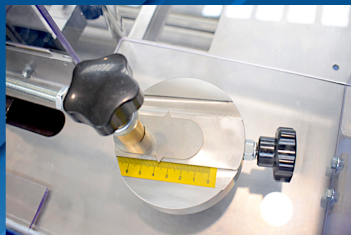
REGOLAZIONE ALTEZZA STRISCE STRIP HEIGHT ADJUSTMENT
