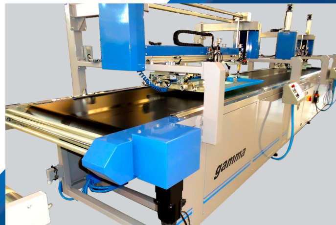
GA-01 - 800 MM (CILINDRO STAMPA + N°2 UNITÀ DI STAMPA SERIGRAFICA) GA-01 - 800 MM (PRINTING CYLINDER + N°2 FLAT SCREEN PRINTING UNITS)
