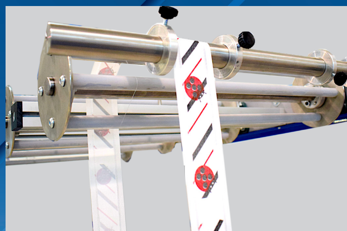
SECONDO PASSAGGIO SOPRA ASPI TEFLONATI SECOND PASSAGE OVER TEFLONATED REELS
