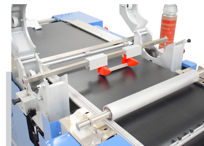
TONDINO ZIGRINATO MANTENUTO DA APPOSITI SUPPORTI CHE NE PERMETTONO LA ROTAZIONE. MILLED ROD WITH SUPPORT THAT ALLOW THE ROTATION.
