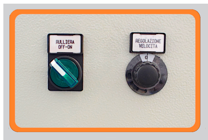
REGOLAZIONE VELOCITÀ ASPI ASP SPEED ADJUSTMENT
