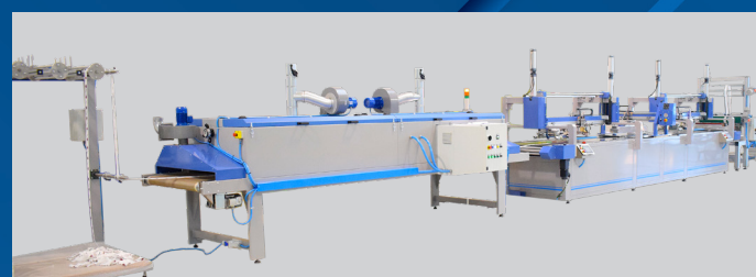
LC-2 - 800X1000 MM + DELTA 8000 (N°2 UNITÀ DI STAMPA SERIGRAFICA) LC-2 - 800X1000 MM + DELTA DRYER 8000 (N°2 FLAT SCREEN PRINTING UNITS)
