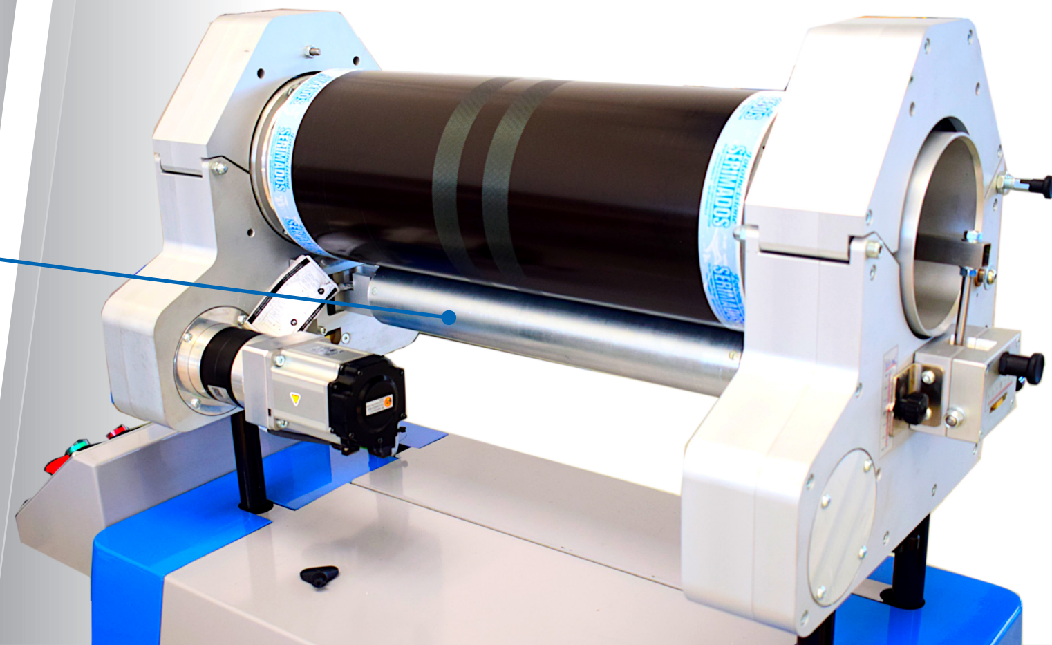
Rullo che preme il nastro sul tappeto adesivo Roller pressing the ribbon on the adhesive belt
