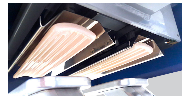
CAPPA A PANNELLI RADIANTI (VISTA DA SOTTO) DRYING HOOD (SEEN FROM BELOW)
