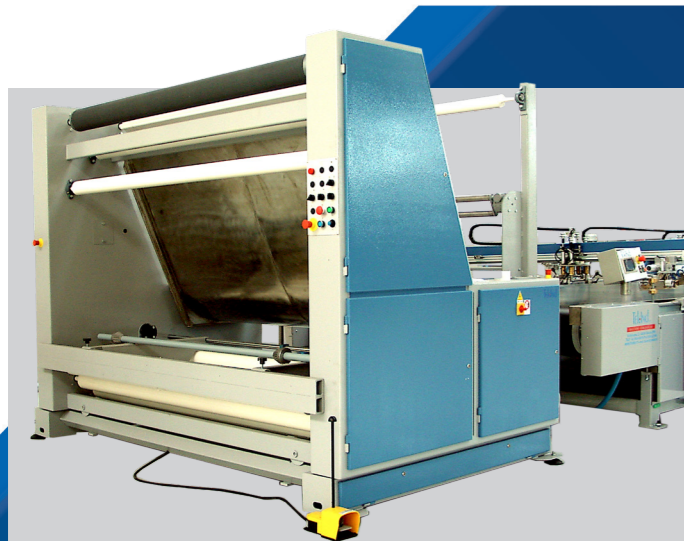
INTRODUZIONE PER BOBINE DI TESSUTO GESTITO DA FOTOCELLULA (VISTA RETRO) INTRODUCTION FOR FABRIC REELS MANAGED BY PHOTOCCELL (REAR VIEW)
