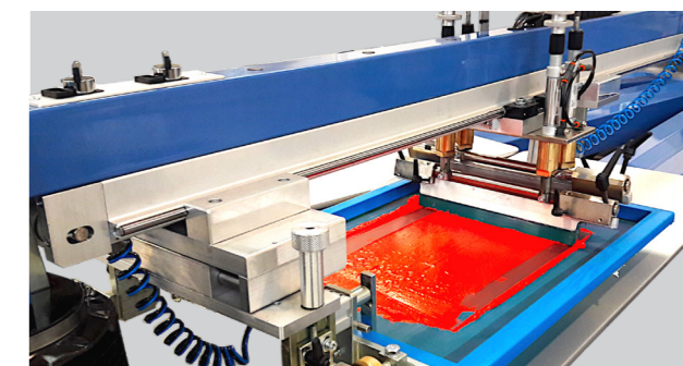
UNITA' DI STAMPA COMPLETA COMPLETE PRINTING UNIT
