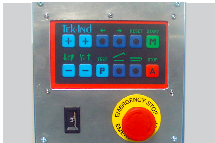
PANNELLO COMANDI UNITÀ DI STAMPA, POSIZIONATO SUL FIANCO SINISTRO O SOPRA L'UNITÀ DI STAMPA PRINTING CONTROL PANEL PLACED ON THE LEFT SIDE OR OVER THE PRINTING UNIT
