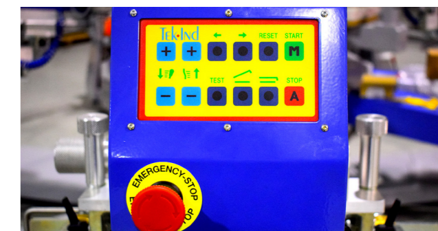
PANNELLO COMANDI SU OGNI STAZIONE CONTROL PANNEL ON EACH PRINTING UNIT
