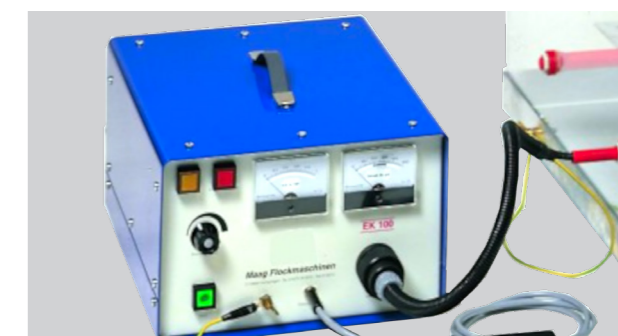
GENERATORE DI FLOCCATURA PORTABILE PORTABLE MANUAL FLOCKING UNIT
