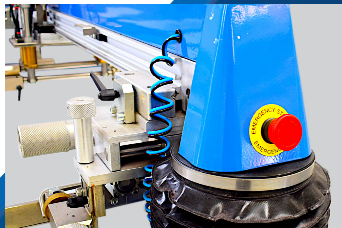
PULSANTE EMERGENZASU OGNI STAZIONE EMERGENCY BUTTON ON ALL STATION
