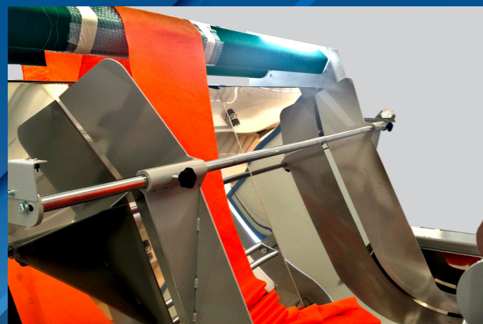
FASE DI FALDATURA NELLO J-BOX. J-BOX LOADING
