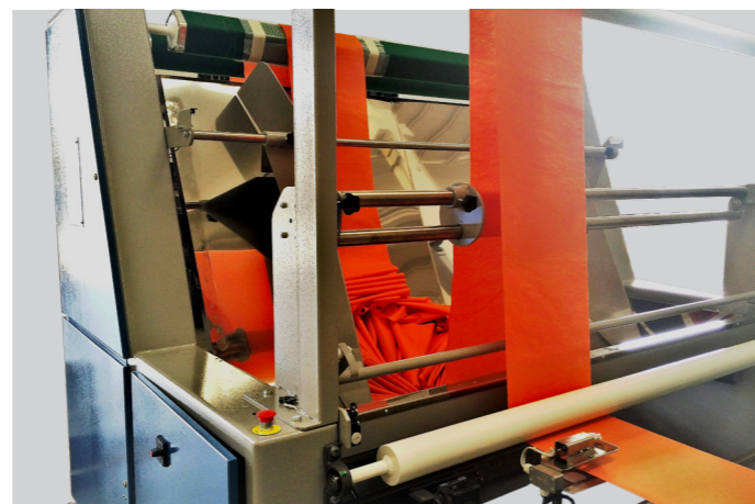
CONTROLLO ALIMENTAZIONE MACCHINA CON FOTOCELLULA. MACHINE FEEDING BY PHOTOCCELL.
