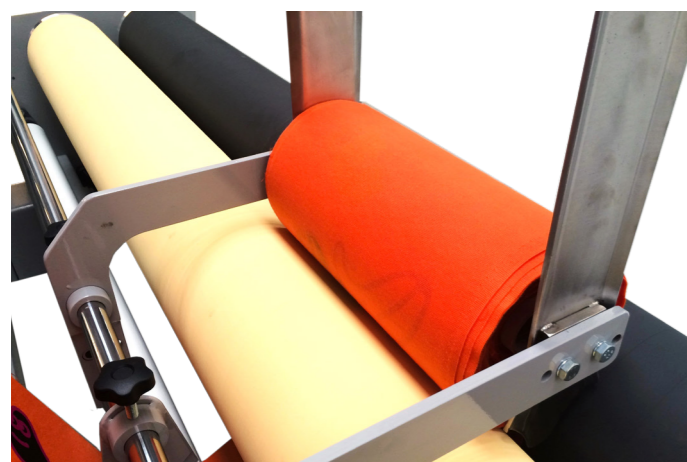
SUPPORTI LATERALI PER ROTOLO IN RIAVVOLGIMENTO SIDE SUPPORTS FOR REWINDING ROLL
