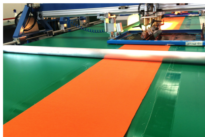
TAPPETO ADESIVO CHE GESTISCE L'AVANZAMENTO DEL ROTOLO. ADHESIVE BELT THAT MANAGES THE ADVANCEMENT OF THE ROLL.
